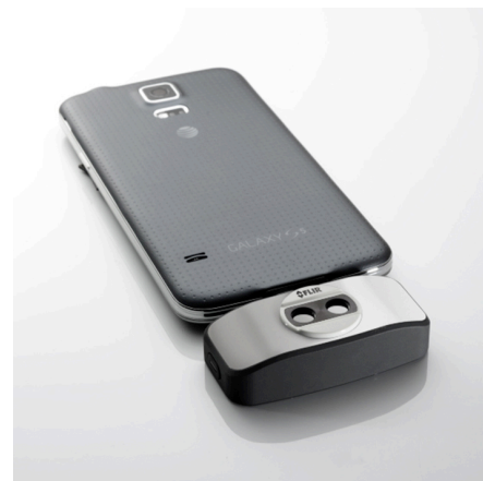
Rysunek 20.3 2015 r.: FLIR One, kamera dla smartfonów iPhone i z systemem Android. Waga: 90 g.
