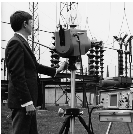
Rysunek 20.2 1969 r.: Thermovision Model 661. Kamera ważyła około 25 kg, oscyloskop — 20 kg, a stojak — 15 kg. Ponadto operatorowi potrzebna była do pracy prądnica prądu przemiennego o napięciu 220 V oraz 10-litrowy zbiornik z ciekłym azotem. Na lewo od oscyloskopu widoczny jest moduł zewnętrzny Polaroid (6 kg).
