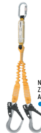
ABM-SCF BW260 amortyzator bezpieczeństwa z podwójną linką o dł. 1,5 m + AZ 011 + 2 x AZ 029 (otwarcie 64 mm)
