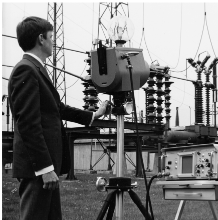
Rysunek 19.2 1969 r.: Thermovision Model 661. Kamera ważyła około 25 kg, oscyloskop — 20 kg, a stojak — 15 kg. Ponadto operatorowi potrzebna była do pracy prądnica prądu przemiennego o napięciu 220 V oraz 10-litrowy zbiornik z ciekłym azotem. Na lewo od oscyloskopu widoczny jest moduł zewnętrzny Polaroid (6 kg).
