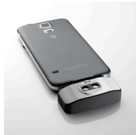
Rysunek 19.3 2015 r.: FLIR One, kamera dla smartfonów iPhone i z systemem Android. Waga: 90 g.
