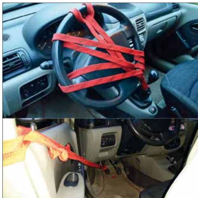
Doraźna osłona na kierownicę i dźwignia do usuwania pedałó
